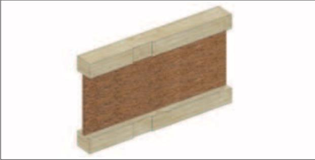
Pour faciliter le positionnement des éléments perpendiculaires, il est possible de réaliser des entailles latérales dans les membrures en lamibois.
