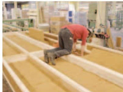
Grâce à l'utilisation de poutres préisolées, les cavités peuvent être facilement isolées avec les panneaux STEICOflex.
